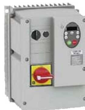
NFU frekvensomformer med direkte motortilslutning og tætningsklasse IP 54 for vægmontage. Har start/stop funktion, ændring af rotationsretning og indtastning af frekvensen
