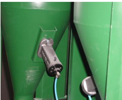
PKL 450 monteret på konussen for en granulat-beholder
