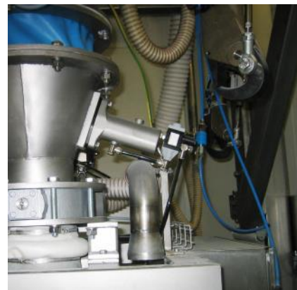
PKL 190 med selvstyring (ST-Kit) monteret på en doseringsstation for pulvermaterialer
